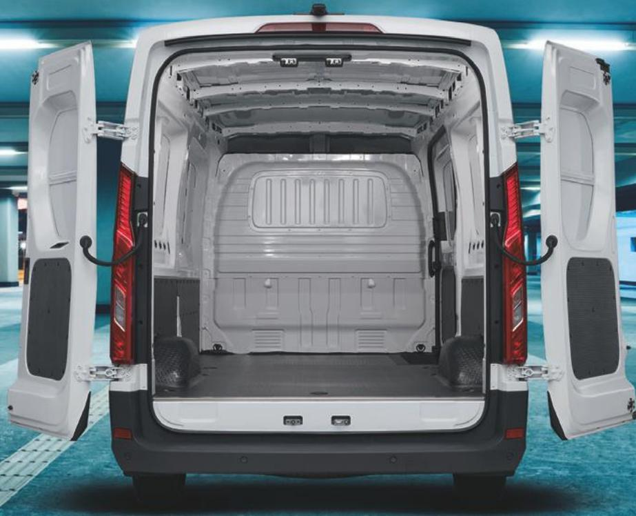
So wird jeder Transport zum reinsten Kinderspiel: Der MAXUS DELIVER 9 bietet Ihnen einen leicht zugänglichen Laderaum mit bis zu 11,5 m<sup>3</sup> Volumen und eine maximale Nutzlast von bis zu 1.140 kg. Dank der großen Schiebetür auf der Beifahrerseite und der weit öffnenden Heckflügeltüren lässt sich der Transporter flexibel be- und entladen.
